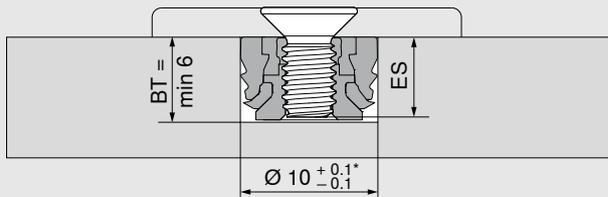
Za pojedinačnu komponentu sustava EXPANDO T moraju se upotrijebiti vijci s navojem M4
